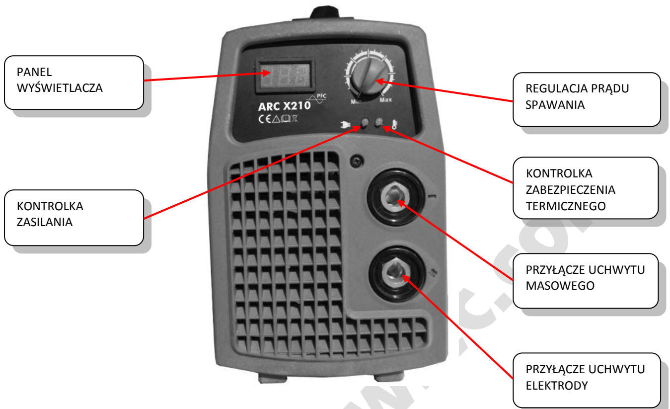
Opis panelu przedniego dla modeli ADORE ARC X160, X200 oraz X210.
